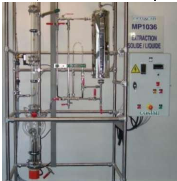
Ilustración 7. Proceso de Extracción continua por Soxhlet
