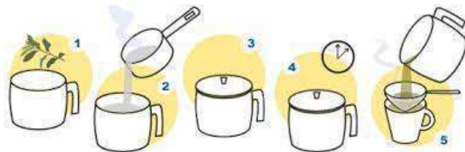
Ilustración 5. Proceso de Extracción discontinuo por infusión
