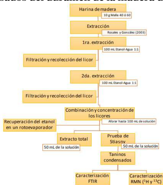
Diagrama 1. Procedimiento para la extracción y caracterización de los taninos condensados del duramen de E. cyclocarpum .
